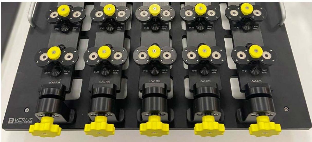
Uma fixação Verus de 48 estações sob medida para medir peças de borracha macia
