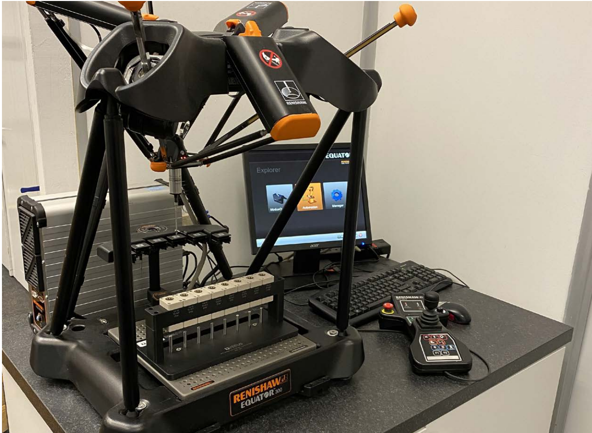
Um dos projetos de fixação da Verus Metrology com tubos e tampas para inspeção no sistema de medição Equator™ 300
