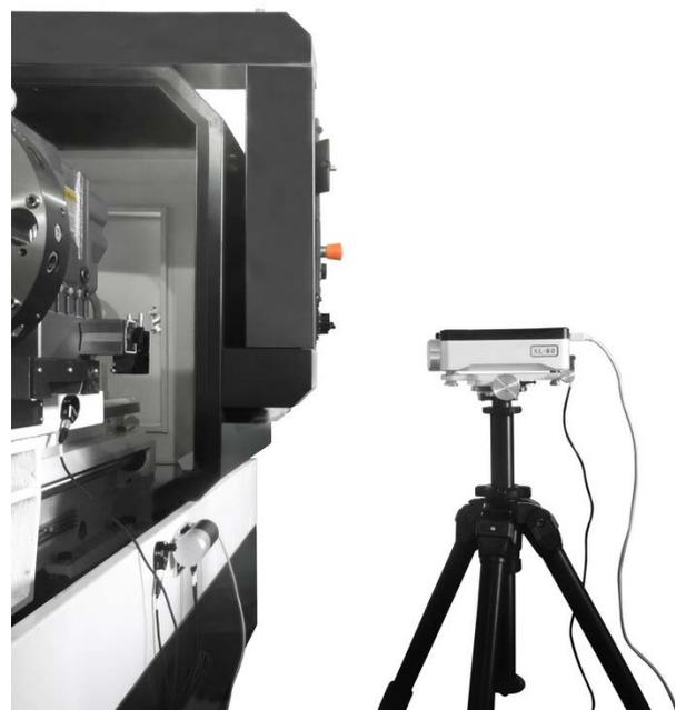
Vérifier la précision des mouvements de machines-outils dotées d'un laser XL-80
