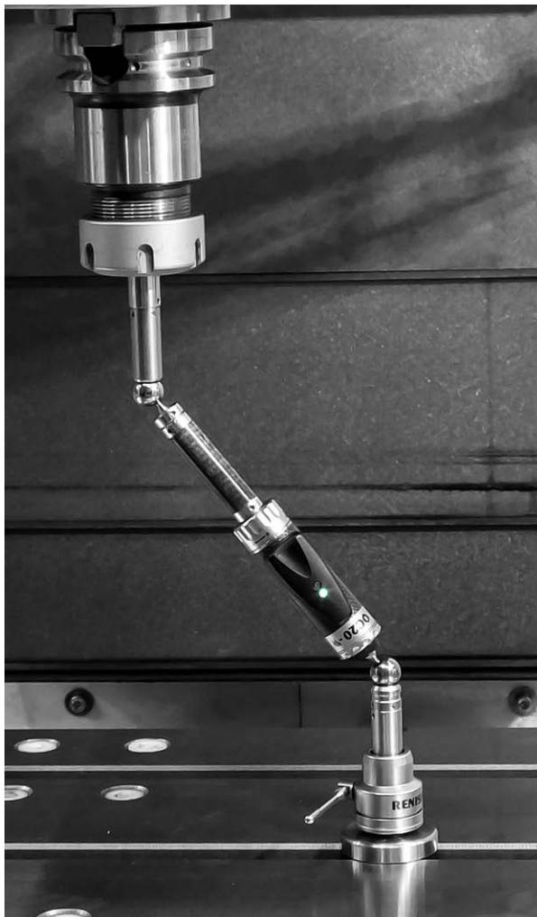
StankoMachComplex utilise le Ballbar QC20-W pour suivre l'état de la machine-outil
