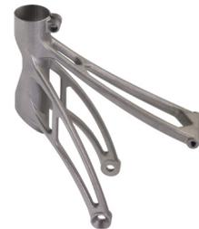
4. Réalisé en alliages de titane sur une machine de fusion laser AM250 Renishaw
