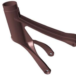
1. Modèle CAO de la tige de selle conçu pour une pièce coulée en alliages d'aluminium
