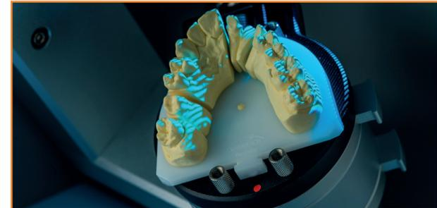
El uso de la avanzada tecnología "blue light" permite un escaneado más rápido y más preciso en zonas estrechas y profundas que los escáneres dentales convencionales. Tan solo con utilizar la menor longitud de onda de la luz azul, el escáner ya no requiere una puerta, haciéndolo más espacioso y con un acceso fácil y rápido.
