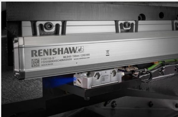
Al contrario que en los métodos de instalación tradicionales, no precisa equipos de diagnóstico adicionales. Los LED de configuración patentados de Renishaw y el minucioso diseño de los accesorios, aseguran una instalación hasta un 90 % más rápida que en los sistemas convencionales.
