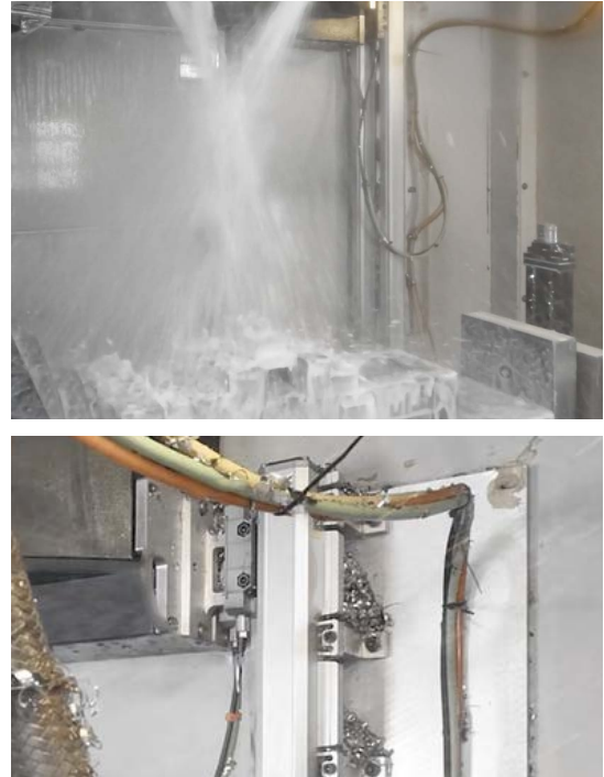
图4. 即使在极端工况下, 为光栅提供净化空气也能有效防止污染物进入栅尺壳体。
