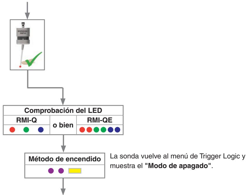
6. Configure los ajustes necesarios de la sonda mediante Trigger Logic.
