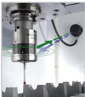
**La trasmissione ottica modulata** viene utilizzata in tutte le sonde "OMP" di nuova generazione, perché garantisce un elevatissimo livello di resistenza alle interferenze luminose.
