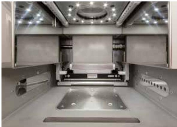
RenAM 500M金属增材制造系统的加工舱
