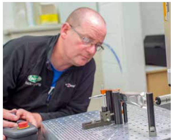
使用雷尼绍PH10机动测座采集触点
