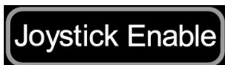
Auf der MCU wird der Joystick über eine Taste aktiviert. Die Taste zur Joystick-Aktivierung sollte auch genutzt werden, um zufällige Maschinenbewegungen zu verhindern. Zum Starten der KMG Bewegungen sind zwei Aktionen erforderlich: Drücken der Joystick-Freigabetaste und Betätigung des Joysticks.
