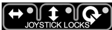
Ermöglichen die Sperrung einer oder mehrerer KMG-Achsen, sodass die Joystick-Auslenkungen für diese Achse ignoriert werden. Auf jeder der Tasten zur Sperrung der Achsen befindet sich eine LED-Anzeige, die bei der Sperrung der jeweiligen Achse rot leuchtet. Zusätzlich wird bei der MCU neben der jeweiligen Achse ein Vorhängeschloss-Symbol (siehe Abbildung unten) angezeigt. Mit diesen Tasten wird die Funktion ein- oder ausgeschaltet.
