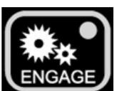
Mittels dieser Taste kann der KMG-Benutzer die Servoantriebe ein- oder auskuppeln, während sich das KMG im manuellen Betrieb befindet. Diese Taste ist als Wechselschalter ausgelegt und besitzt eine entsprechende LED, die den Betriebszustand der Servoantriebe anzeigt. Die (in die Taste integrierte) LED ermittelt die verschiedenen Betriebszustände, wie unten aufgeführt. Bei der MCU5 und MCU V
