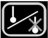
Mittels dieser Taste (die das Messtastersignal deaktiviert) kann der KMG-Bediener das KMG bewegen, während der Messtaster ausgelöst oder nicht angeschlossen ist.
