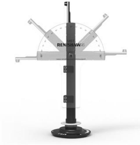
4. Das Gelenkstück mit einem Drehmoment von 0,4 Nm bis 0,5 Nm festziehen und das MST anschließend vom SFH Tasterhalter entfernen.
