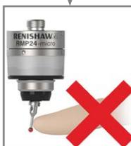
Um zu bestätigen, dass ein Master-Reset erforderlich ist, lassen Sie den Taster los, während die Status-LED gelb blinkt, und halten Sie den Taster dann nochmals ausgelenkt, bis die LED achtmal gelb geblinkt hat.
