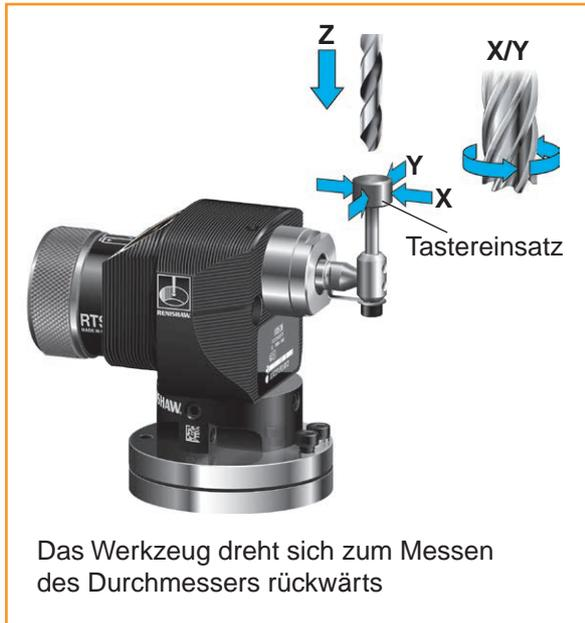
Für die Längenmessung und Bruchkontrolle wird das Werkzeug in der Z-Achse der Maschine zur Tastplatte verfahren.
