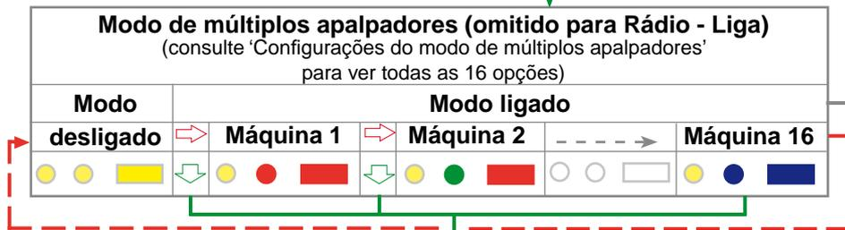
**NOTA:** Se não for feita nenhuma alteração no modo de múltiplos apalpadores, o ato de defletir a ponta por mais de 4 segundos fará com que as configurações do apalpador voltem para 'Para alterar o método de ligar'.
