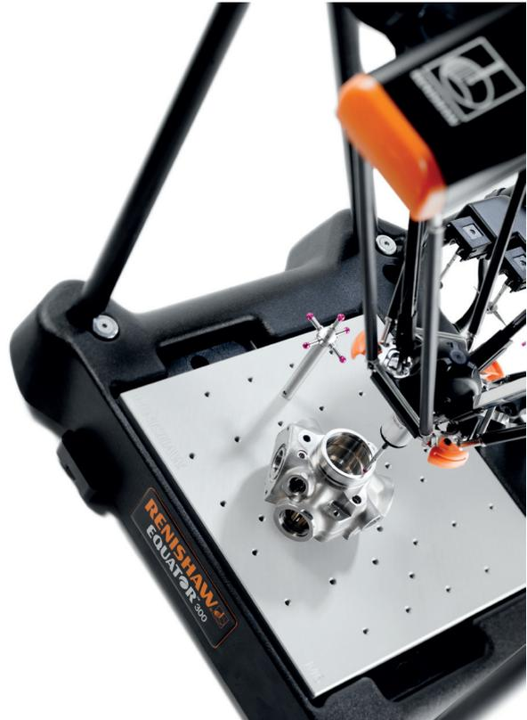
Equator utiliza una estructura 'cinemática paralela' para la exploración a alta velocidad con una repetibilidad impresionante
