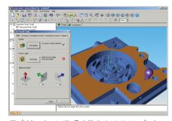
Active Editor Pro はスタンドアロンアプリケーションで、その他の CAD/CAM パッケージを必要としません。 これにより、サポートされている 3 次元\*の CAD モデルをインポートしたり、テキスト入力を使用して、新しい NC プログラムや既存の NC プログラムに計測ルーチンを追加できるようになります。
