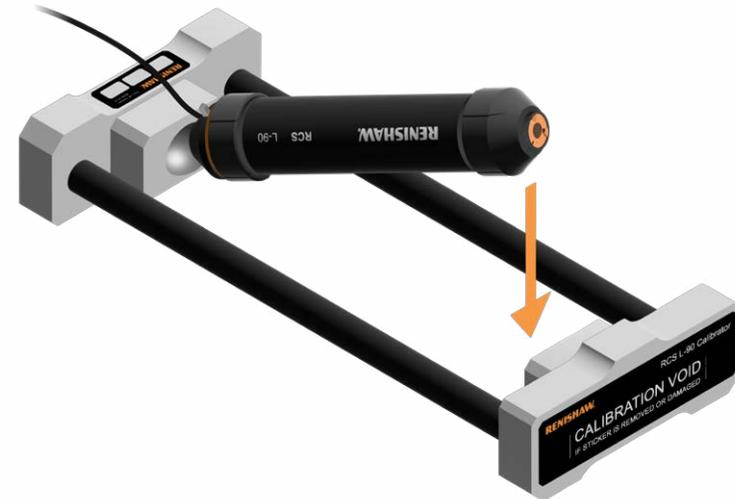
2. 伸展球杆仪, 使伸缩支撑杆的另一端到达校准装置的另一端球面。确保以磁吸方式将RCS L-90连接至校准装置。
