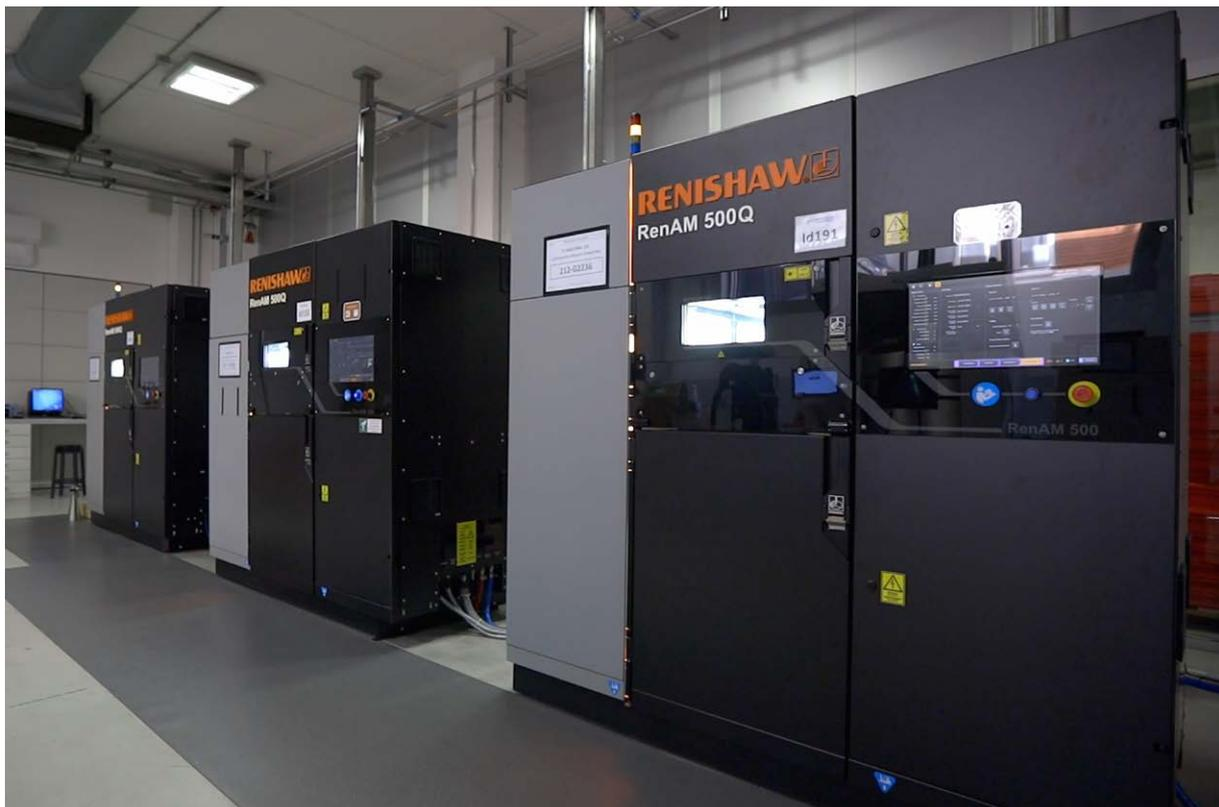
Inoltre, il sistema è dotato di sistemi automatici per la gestione delle polveri, grazie ai quali la qualità del processo rimane costante mentre i tempi d'intervento dell'operatore diminuiscono e i livelli di sicurezza aumentano.
