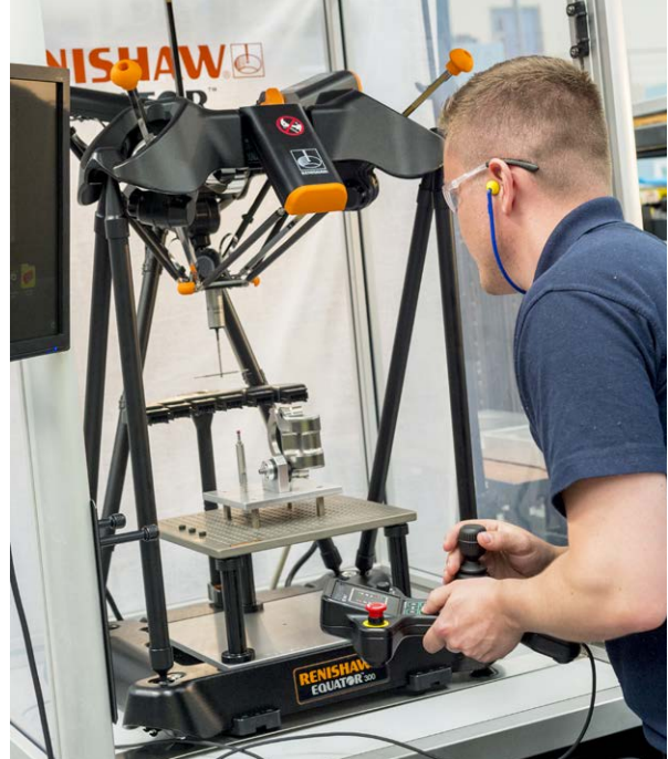
프로그래밍된 항공우주 부품을 검사하는 데 사용되고 있는 Equator 시스템
