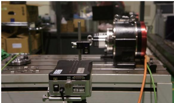
XL-80激光干涉仪搭配XR20-W回转轴校准装置
