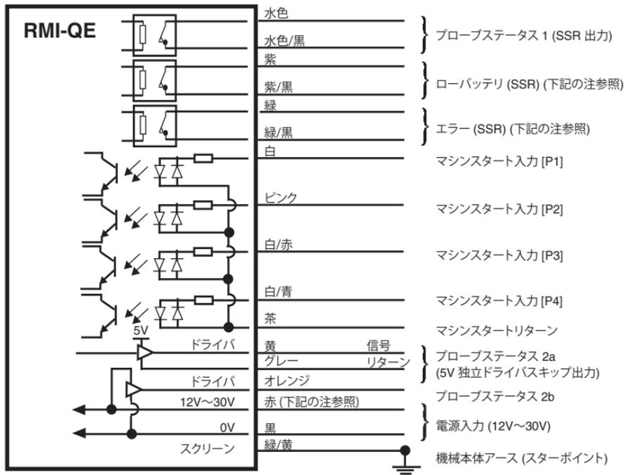
**注意:** 供給電源の 0V は機械アース (スターポイント) へ接続してください。適切に配線されていれば、マイナス電源も使用できます。
