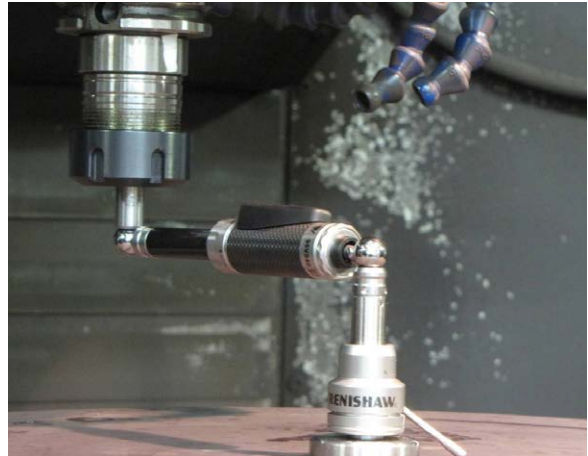
QC20无线球杆仪在立式加工中心上执行测试
