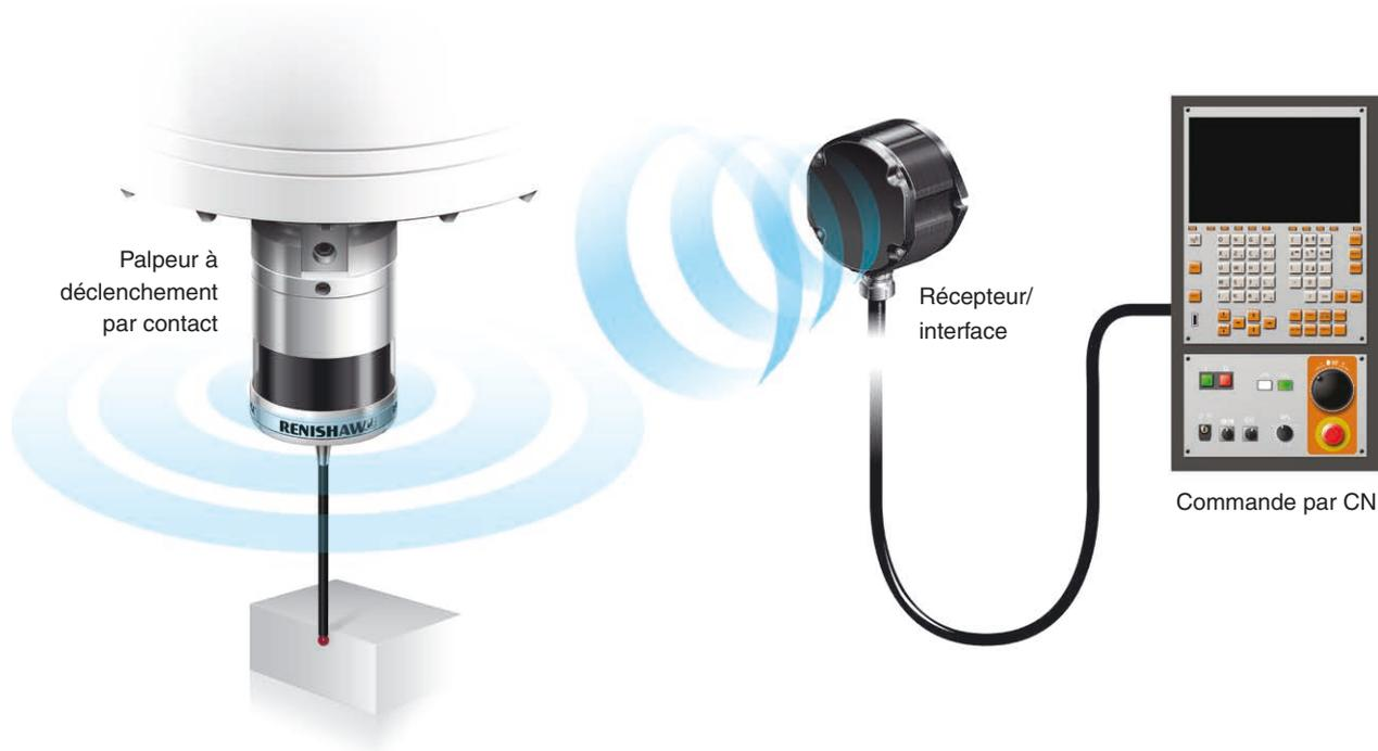
Un système à transmission radio Renishaw assure la communication entre le palpeur et l'automate. Il comprend :
