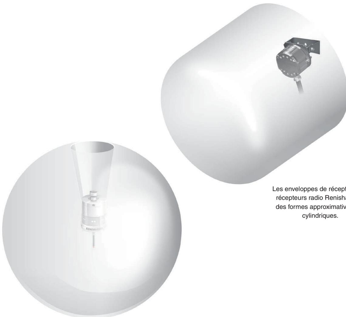
Les enveloppes de réception des récepteurs radio Renishaw ont des formes approximativement cylindriques.
