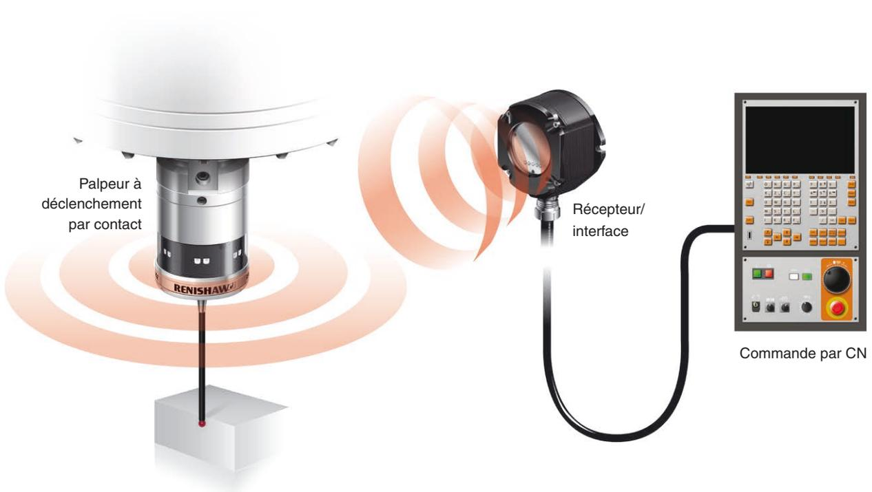
Un système de transmission optique Renishaw utilise les infrarouges pour communiquer entre le palpeur et l'automate. Il comprend :
