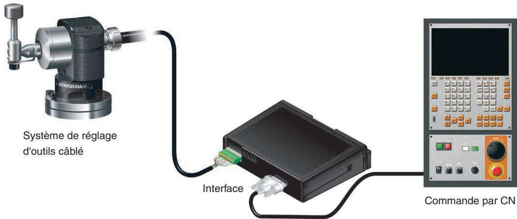
Un système de palpéage câblé est la forme la plus simple de transmission. En général il comprend les éléments suivants :
