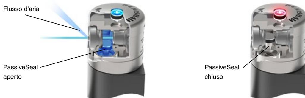
PassiveSeal è stato progettato appositamente per le unità di trasmissione e ricezione di NC4 e viene attivato dalla pressione dell'aria. Quando la fornitura di aria si attiva e raggiunge l'unità NC4, PassiveSeal si abbassa per consentire al fascio laser di uscire attraverso il foro MicroHole. In caso di malfunzionamento o disattivazione del sistema di fornitura dell'aria, PassiveSeal si alza automaticamente per coprire il foro MicroHole e impedire l'ingresso di refrigerante o altri contaminanti.
