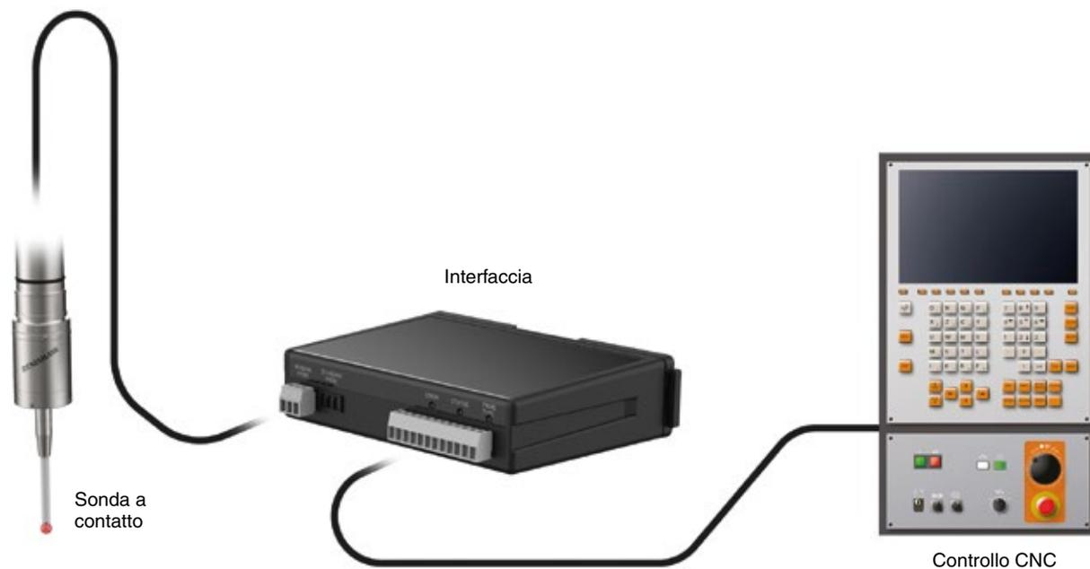
Una sonda via cavo sfrutta il sistema di trasmissione più semplice e di solito include i seguenti elementi:
