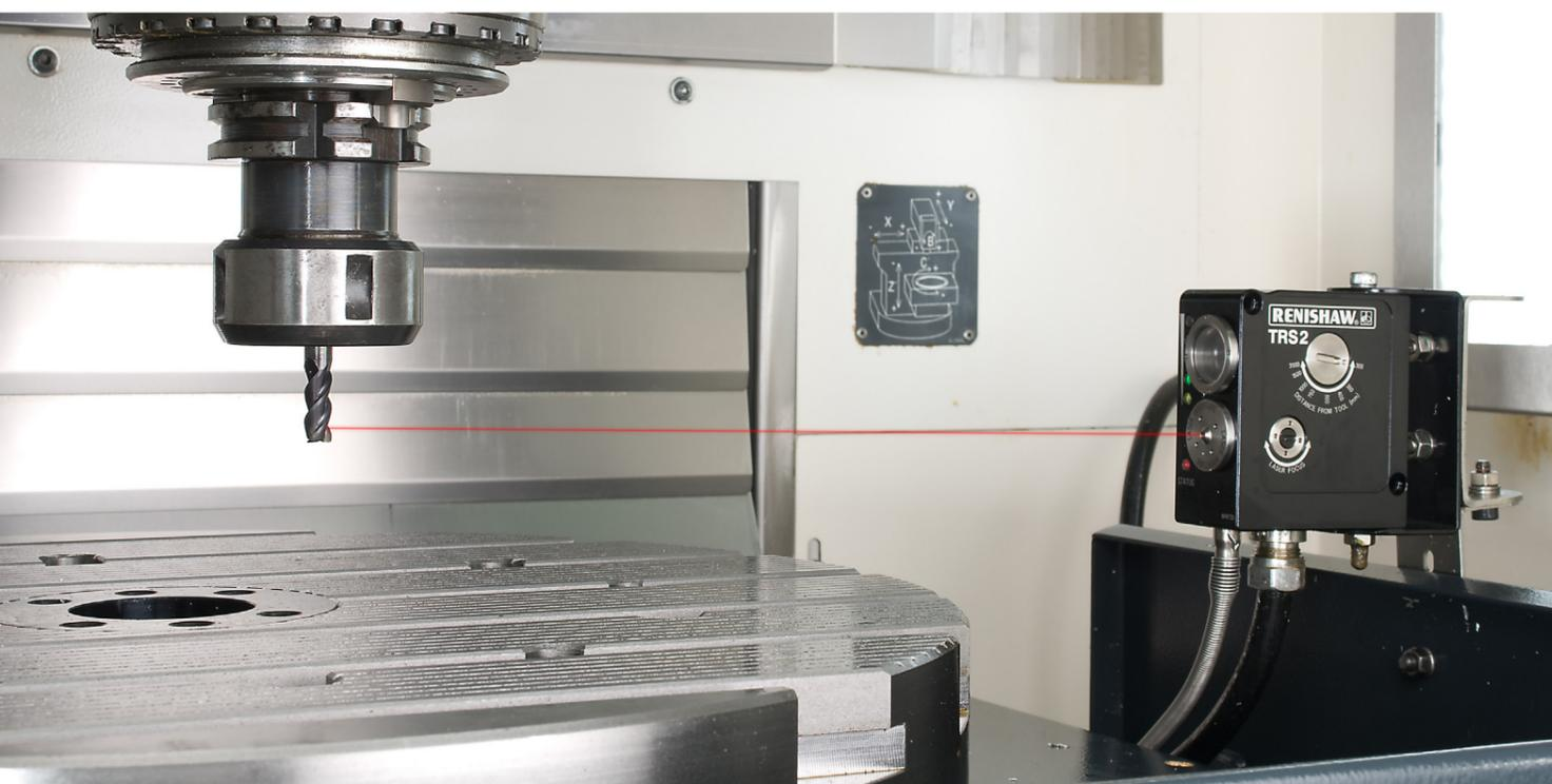
Hinweis 1 Jedes TRS2-System wird mit einem blauen HSS-Spiralbohrer mit Ø0,5 mm (Farnell Artikelnummer 203778) am Arbeitspunkt 350 mm geprüft. Testbedingungen: Trockenes, mit 5000 U/min rotierendes Werkzeug, das vom TRS2 innerhalb von 1 s erfasst werden muss.
