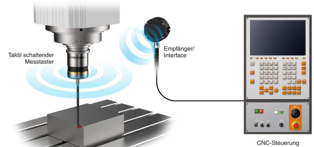
Ein Funkübertragungssystem von Renishaw sorgt für die Kommunikation zwischen dem Messtaster und der Werkzeugmaschinensteuerung und umfasst Folgendes:
