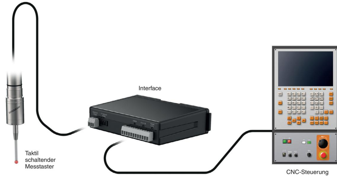
Ein kabelgebundenes Messtastersystem besitzt die einfachste Form von Übertragungssystem und umfasst Folgendes:
