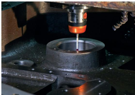
將量測渦輪增壓器外殼的循環時間大幅降低 90%
