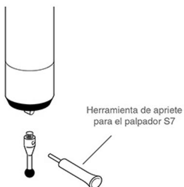
Para ajustar un palpador a una sonda de disparo por contacto Renishaw, inserte el palpador roscado adecuado o adaptador de palpador en el soporte del palpador y apriételo con firmeza utilizando la herramienta para palpador S7 proporcionada. Si se aprieta el palpador mediante otro medio que la herramienta para palpador proporcionada (por ej. llaves de apretar tuercas, trépanos, etc.) se puede producir una avería interna en el mecanismo de la sonda.
