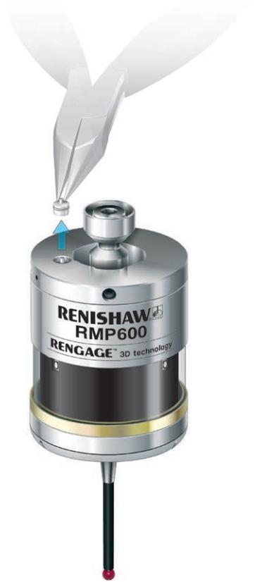
**NOTA:** Para utilizar la sonda RMP600 con interruptor en el cono, retire el tapón de la parte trasera de la sonda con unos alicates y cámbielo por una bobina (A-4038-0303).
