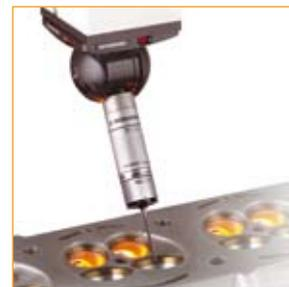
Датчик сканирования SP25M – быстрый и непрерывный 'захват' данных
