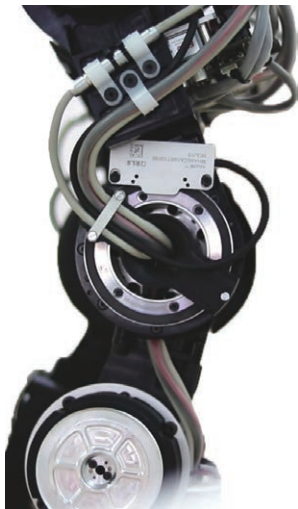
安装有AksIM™绝对式磁旋转编码器系统的REEM-C膝部关节
