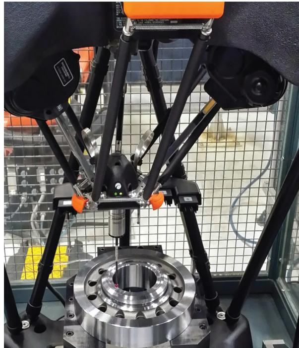
O sistema Equator tornou fácil para a Tremec medir cada característica controlada das engrenagens no chão de fábrica. A medição leva 2½ minutos e elimina a necessidade de medir algumas características na sala de metrologia, que tomava 20 minutos por peça, além do tempo de equalização da temperatura no novo ambiente.
