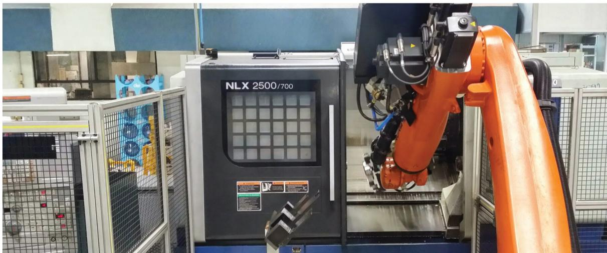
Uma célula de trabalho consiste de dois tornos, um marcador, um detector de peças, o robô e o sistema de medição Equator.
