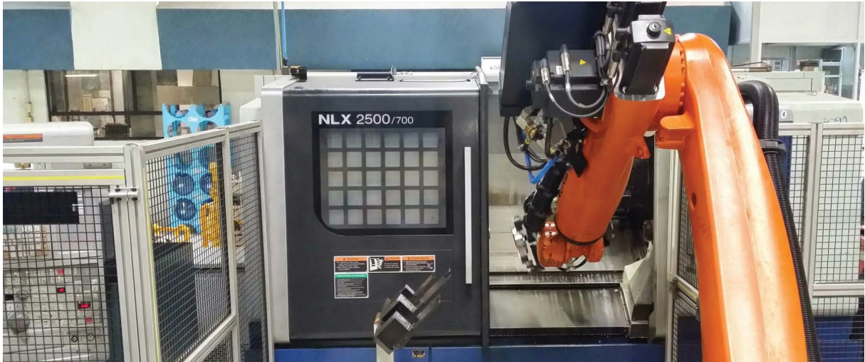
一个制造单元由两台车床、一个打标机、一个零件探测器、一个机器人和一台Equator比对仪组成。
