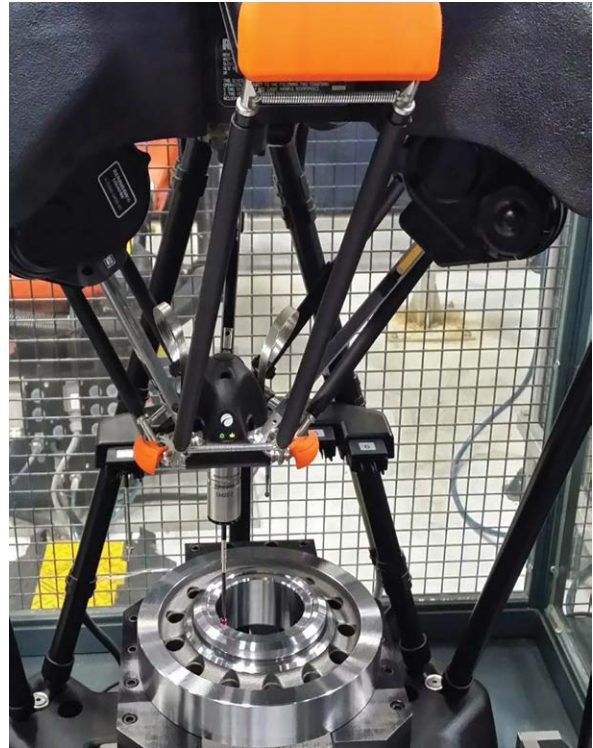
Equator比对仪使Tremec能够在车间轻松完成齿轮所有控制特征的测量，此过程仅耗时2.5分钟。
