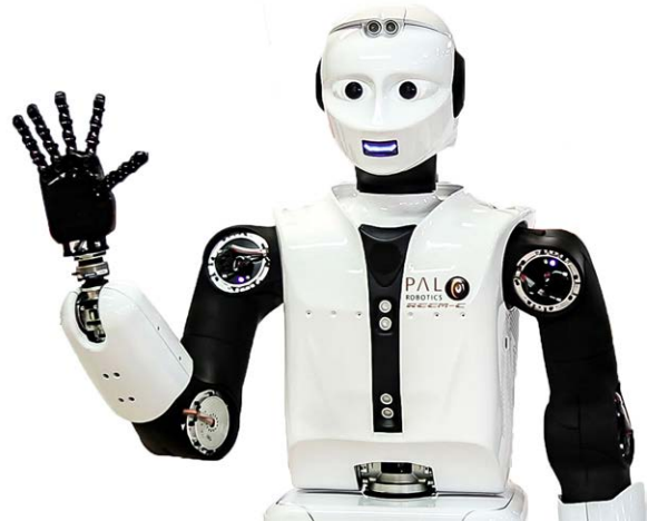
REEM-C 將 AksIM 和 Orbis 旋轉編碼器整合至手肘和手腕關節上。
