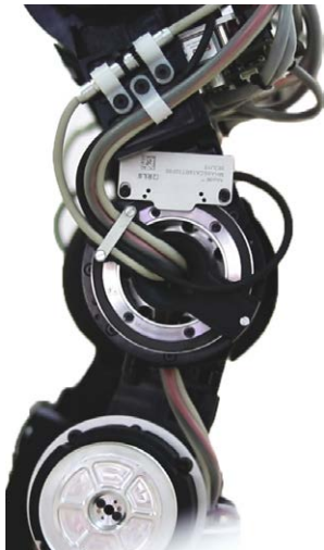
REEM-C 的膝蓋關節採用 AksIM™ 絕對式旋轉編碼器
