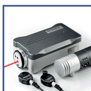
Kalibracioni laser XL-80 kompenzuje greške mašina alatki i KMM za povećanje preciznosti.
