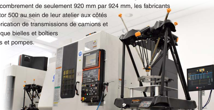
Système d'inspection Equator 500 pour les pièces de grandes dimensions
