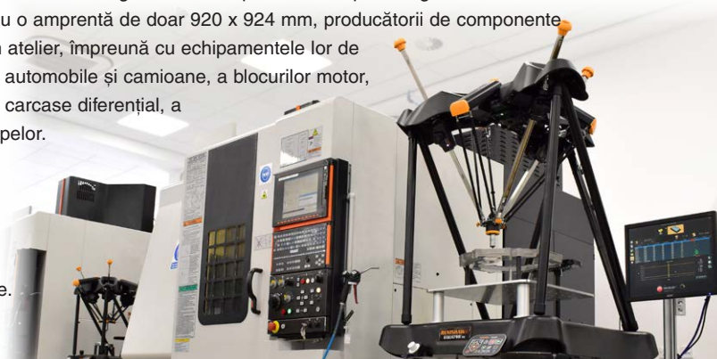
Sistemul de control Equator 500 pentru piese de dimensiuni mai mari
