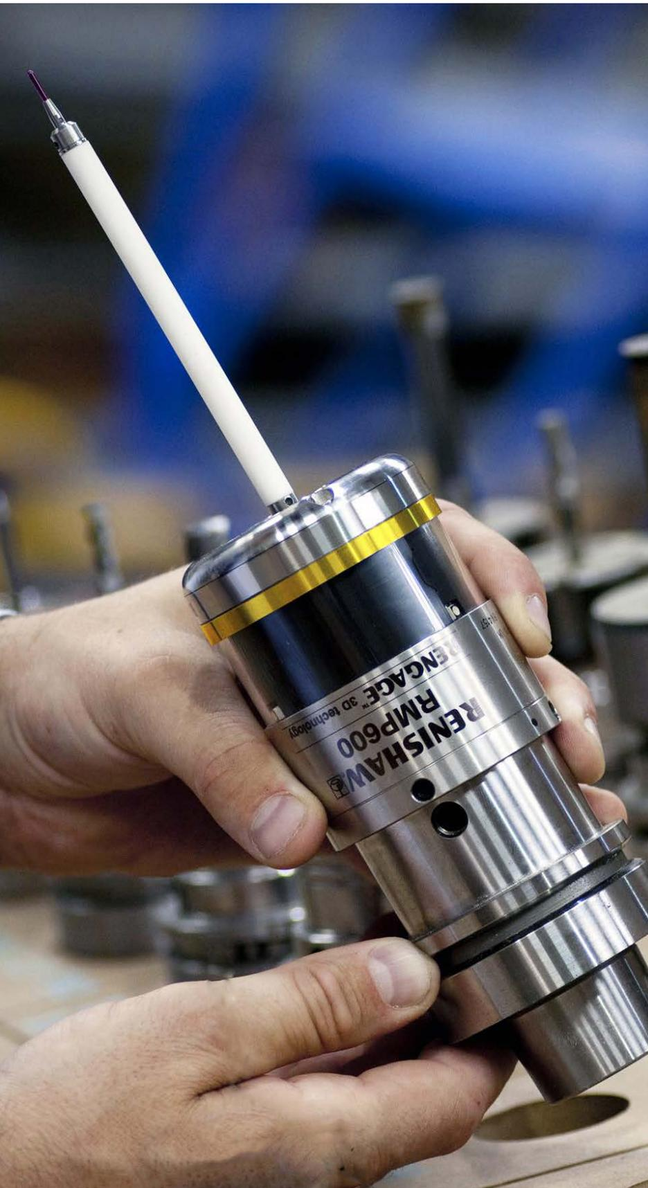
// Wir sind mit der Genauigkeit des RMP600 und vor allem der damit erzielten Reduzierung der Ausschussteile im weiteren Verlauf der Fertigung sehr zufrieden. Es handelt sich um große, teure Werkstücke und mithilfe des Messtasters können wir Fehler ermitteln und vermeiden.
