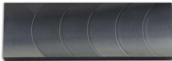
図 4: 6 種類の異なる表面状態を示す 6 個の切削面を刻んだテストパーツ
