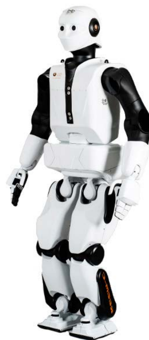
Il robot umanoide bipede a grandezza naturale REEM-C di PAL Robotics
