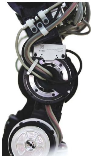
Articolazione del ginocchio del REEM-C con encoder rotativo assoluto AksIM™
