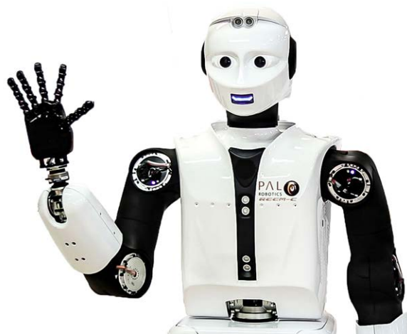
Il REEM-C con gli encoder rotativi AksIM e Orbis integrati nelle articolazioni del gomito e del polso.
