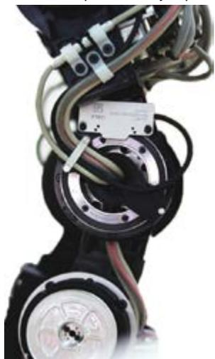
Articulation du genou REEM-C avec système de codeur rotatif absolu Aksim™
