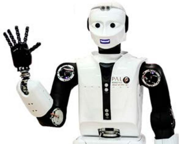
REEM-C avec les codeurs rotatifs Orbis et AksIM intégrés dans les articulations du coude et du poignet.
