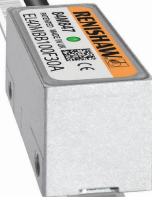
Das auf derselben industrierprobten Technik wie RESOLUTE™ beruhende System EVOLUTE ist ein absolutes, berührungsloses, optisches Messsystem mit 50 µm Teilungsperiode, das verbesserte Installationstoleranzen sowie eine höhere Unempfindlichkeit gegenüber Verschmutzungen für Großserienanwendungen bietet, die höchste Funktionssicherheit verlangen.
