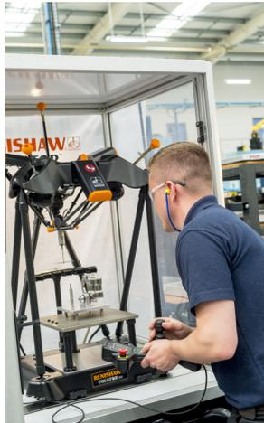
Equator比对仪使用已编程序检测航空航天设备零件
