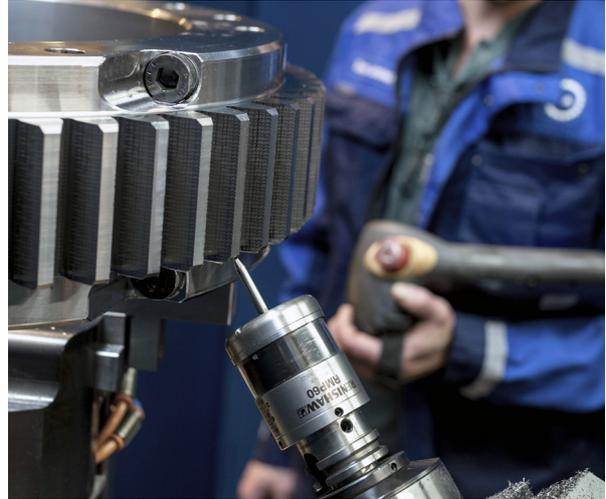
雷尼绍RMP60测头在去除毛边后确认成品齿轮的尺寸
