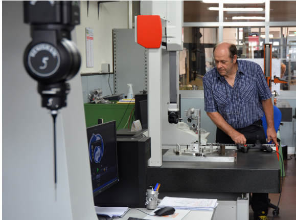
R. Busi的质量负责人Paolo Orlandi使用五轴技术测量工件
