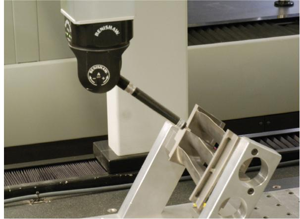
Renishaw PH20 測頭檢查 AEREO – EMA 的多葉片
