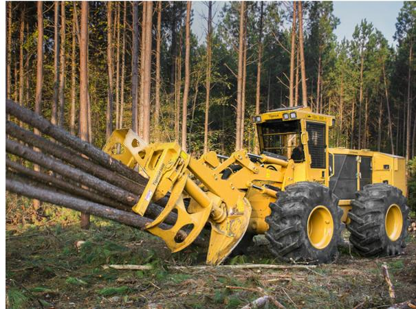
Cortadora-apiladora 724G (Imagen cortesía de Tigercat)
