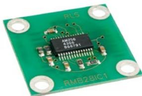
Los módulos de encóder magnético rotatorio se componen de un actuador magnético y una placa sensora separada. La extensa gama de formatos permite integrarlos fácilmente en los sistemas originales del fabricante. La gama de encóderes magnéticos RLS genera formatos de salida incremental y absoluta, que incluyen cuadratura AB, tensión analógica, conmutación UVW y tensión lineal.
