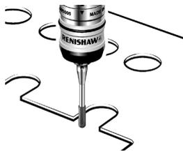
薄板材の穴測定に使用されるものです。また、ネジ山の測定やネジ穴の中心位置測定等を行うことも可能です。先端に半球がついたシリンダースタイラスは、X、Y、Z 全方向に対し基準設定と測定が可能であるため、表面測定もすることができます。
