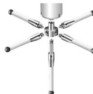
スタイラスセンターは、スタイラスを組み合わせるジョイントで、1本のプローブでさまざまな方向が測定できるようになります。ネジ径が同じ 5 つのスタイラスを組み合わせることで、ニーズに合ったスタイラスを構成することができます。
