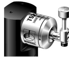
工具測定用スタイラスには、一般的に四角形のスタイラスが取り付けられており、ネジ式もしくはストレートシャフト式の取り付け方式があります。スタイラスの表面は、直角および平行に研磨が行われています。マシニングセンター用の TS27R 工具計測プローブには、超硬ディスクスタイラスを取り付けることもできます。
