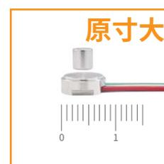
RM08 は省スペース性に優れた、超小型で密閉式の高速度磁気式ロータリエンコーダです。2個のパーツから構成される非接触式方式のため、パッキンやベアリングが不要で、長期にわたる信頼性と簡単な取付けが実現しています。
